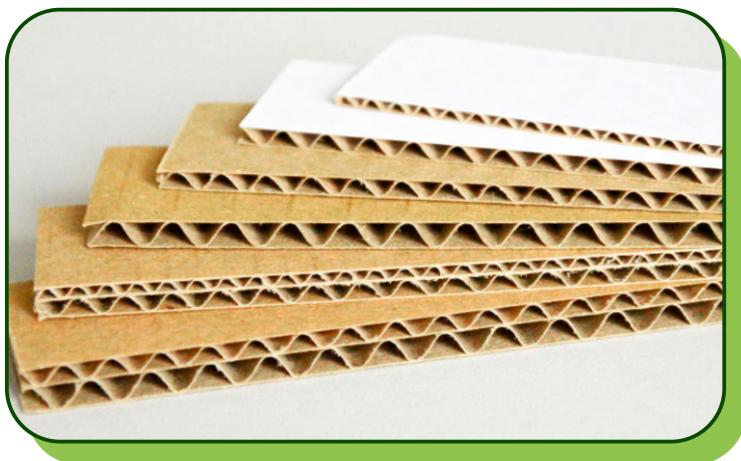
Поставки исходного сырья производятся железнодорожным и автотранспортом. Исходное сырье (бумага и картон) проходит цепь переработки на высокоскоростной линии для производства гофрокартона (гофроагрегате) мощностью 70 000 000 кв.м в год, выпуская гофрированную бумагу и картон в заготовках (от двух до пятислойных) различного размера, шириной и высотой профиля с различными характеристиками.
